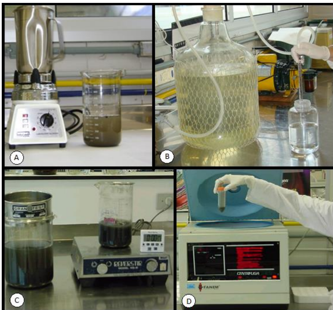
Figura 4. A - Homogeneização de amostra em homogeneizador blender . B - Aspiração do sobrenadante por bomba vácuo/pressão. C - Processo de peneiramento da amostra com peneira de malha 50 mesh . D - Centrifugação de amostras em centrífuga de bancada com rotores swinging-bucket .
