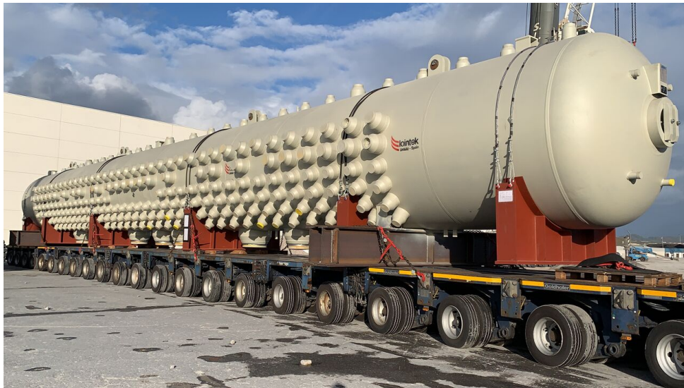
Figura 10 – Balão de vapor de 30m a ser instalado em uma fábrica de celulose
