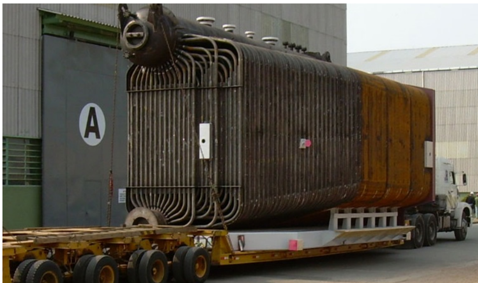
Figura 11 – Caminhão transportando balões pré-montados de uma caldeira aquatubular
