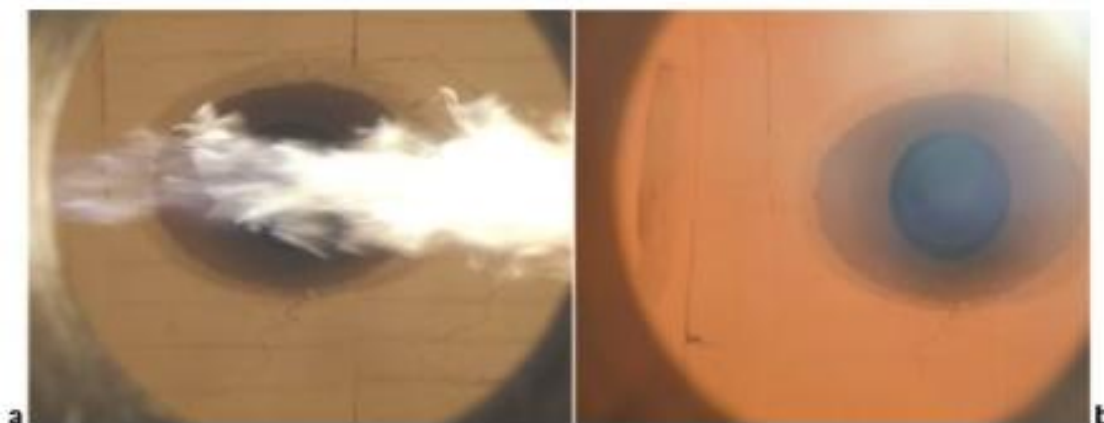
Figura 1 – Regimes de combustão: a) convencional b) sem chama visível
