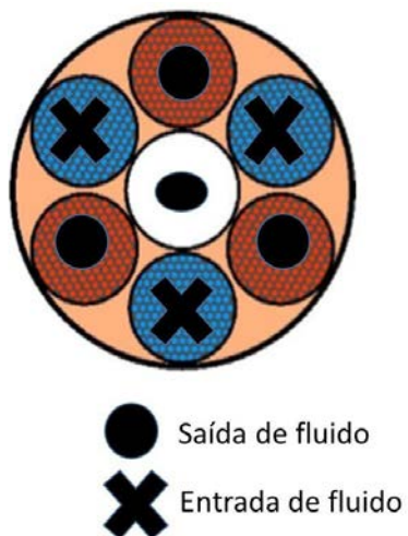
Figura 23 – Configuração do queimador Caso III – Injeção intercalada
