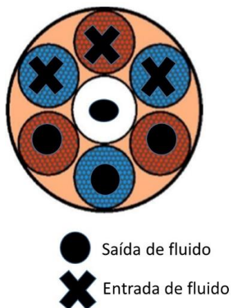
Figura 17 – Configuração do queimador Caso II – Injeção superior
