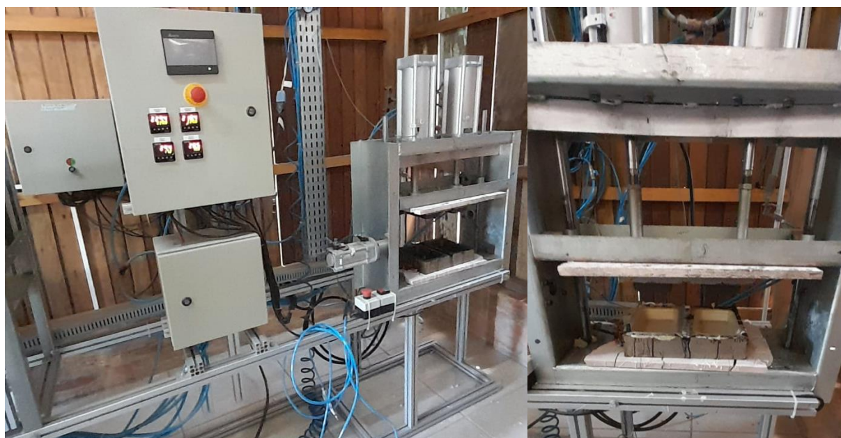
FIGURA 12: Equipamento do processo de termo-expansão para a produção das embalagens biodegradáveis do tipo espuma.
