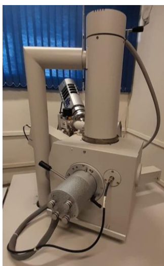
FIGURA 14: Microscópio eletrônico de varredura FEI, modelo Quanta 200.
