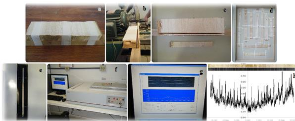
Figura 15. Etapas do preparo das amostras e realização dos ensaios de raios X: (a) colagem da amostra em suporte de madeira; (b) dupla serra circular utilizada para a retirada de amostras com espessura constante; (c) retirada do filete de 2 mm de espessura; (d) amostras prontas em estágio de climatização; (e) amostra na base do equipamento; (f) equipamento de densitometria de raios X; (g) tela do software utilizado no ensaio de densitometria de raios X; (h) perfil diametral de densidade aparente
