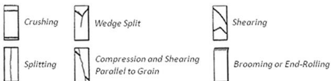
Figura 12: Tipos de ruptura de corpos de prova do ensaio de compressão paralela às fibras de acordo com a norma americana ASTM D143-94 (ASTM, 2007)
