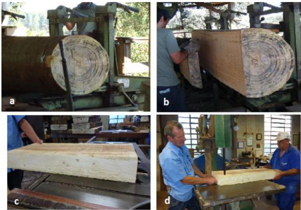
Figura 4. a; b) Desdobro do pranchão central das toras de Schizolobium parahyba ; c;d) Operações na marcenaria da FCA/UNESP, Botucatu para confecção dos corpos de prova com sobre-medida
