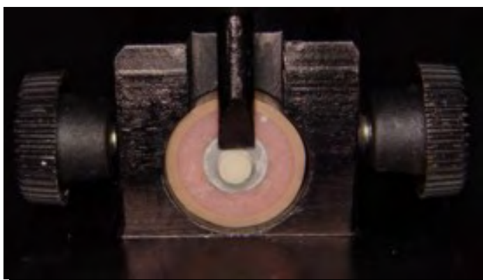
FIGURA 9 – Dispositivo utilizado para a realização do teste de resistência ao cisalhamento.
