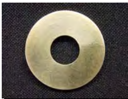
FIGURA 1 – Matriz metálica para a confecção das amostras em metal e em cerâmica.
