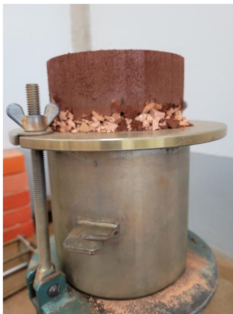
Figura 19 - Extração do corpo-de-prova com cravamento do agregado seco
