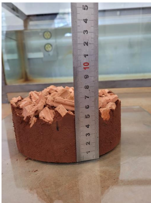
Figura 36 - Medição do cravamento no CP5
