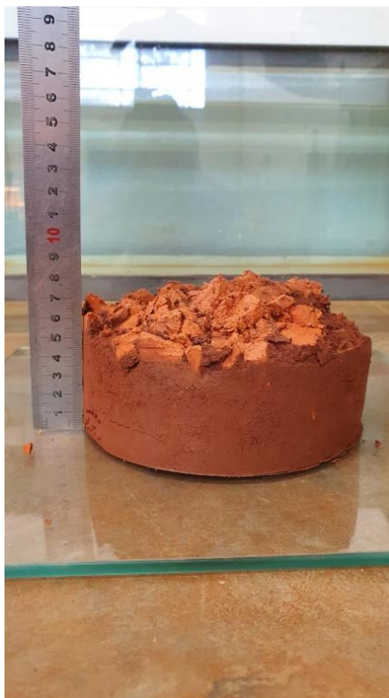
Figura 24 - Medição do cravamento no corpo-de-prova com agregado saturado
