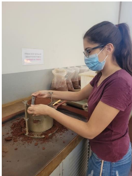
Figura 11 - Excesso de solo compactado acima do molde sendo removido e rasado
