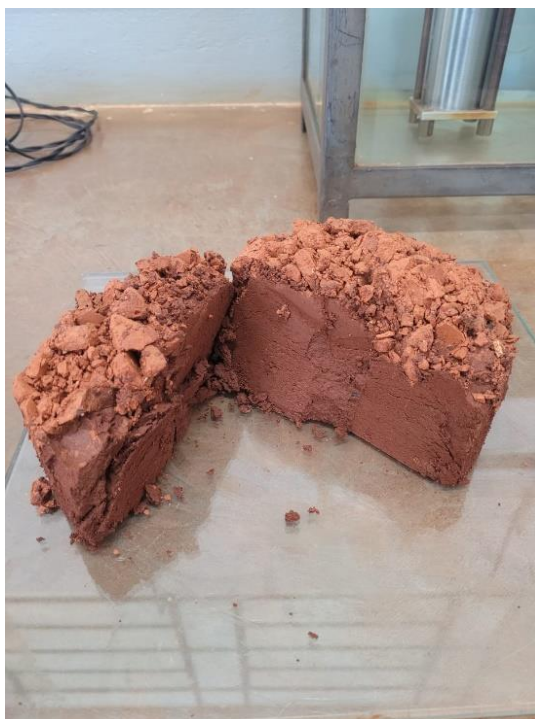
Figura 25 - Corpo-de-prova extraído do cilindro e com agregado saturado
