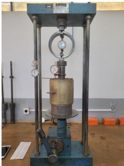
Figura 13 - Prensa utilizada para a penetração no ensaio CBR
