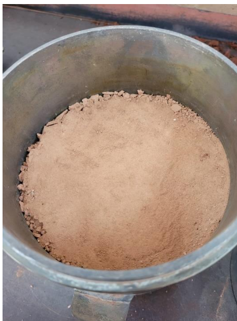
Figura 17 - Corpo-de-prova com agregado seco após a compactação e retirada do anel de fundo
