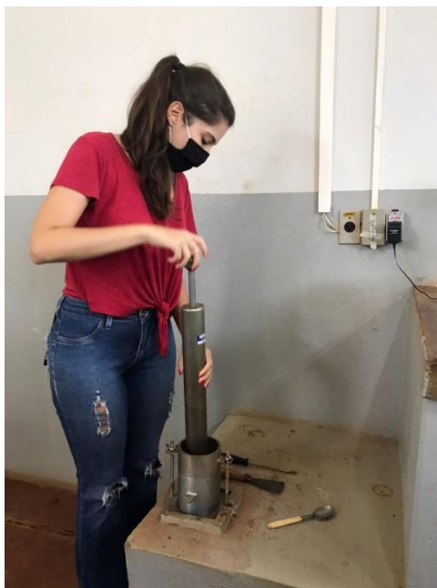
Figura 9 - Execução do ensaio de compactação Proctor
