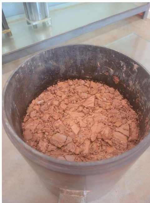
Figura 22 - Vista do corpo-de-prova com agregado saturado após a compactação
