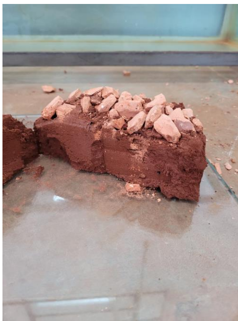
Figura 21 - Corpo-de-prova com agregado seco extraído do cilindro
