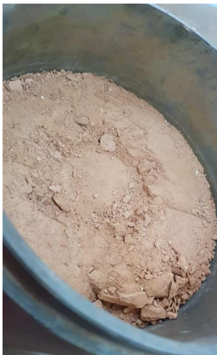
Figura 18 - Vista do corpo-de-prova com agregado seco após a penetração da prensa
