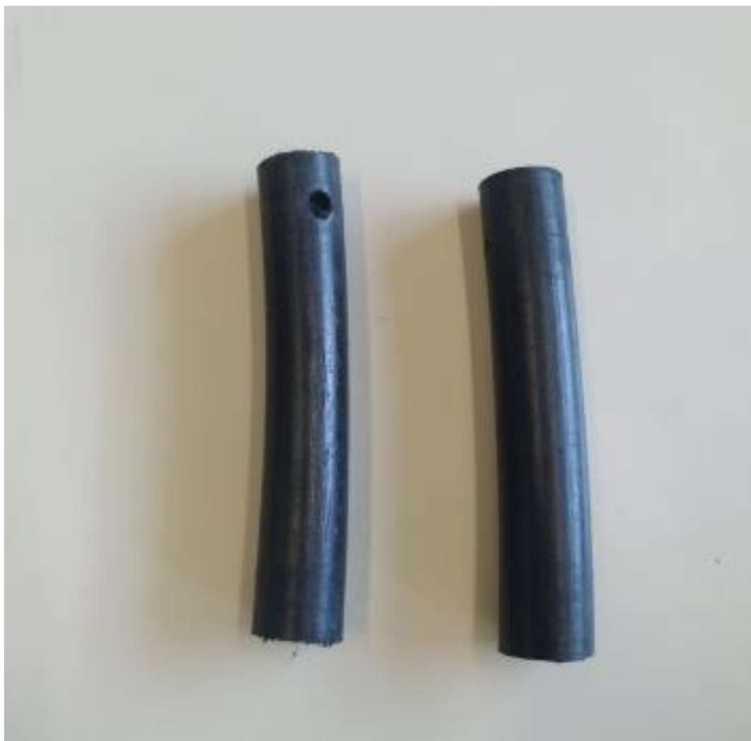
Figura 10 – Dois pedaços de cano de eletroduto com aproximadamente 20 cm de comprimento com um furo na parte superior
