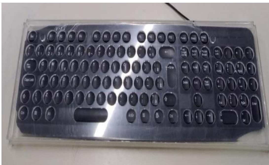
Figura 3 – Imagem de um teclado com uma colmeia: suporte em acrílico com elementos vazados sob as letras, números e símbolos para facilitar a digitação
