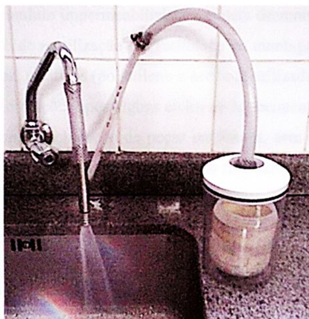
Figura 26- Desaerador (trompa a jato d'água)
