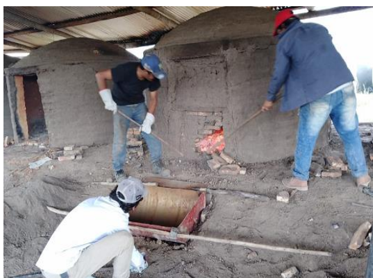
Figura 10 - Lado esquerdo (a) – abertura da porta inferior para ignição de oxigênio dentro do forno; lado direito (b) – Uso do soprador adaptado elevando a temperatura do forno
