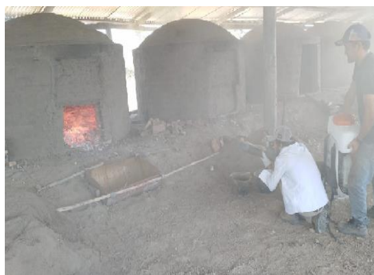
Figura 10 - Lado esquerdo (a) – abertura da porta inferior para ignição de oxigênio dentro do forno; lado direito (b) – Uso do soprador adaptado elevando a temperatura do forno
