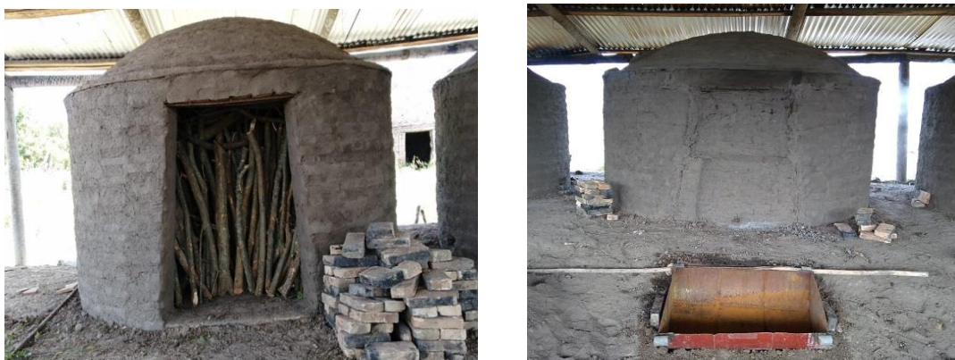
Figura 9 - Lado esquerdo (a) – forno abastecido com lenha alinhada no sentido vertical; lado direito (b) – Forno em processo de carbonização
