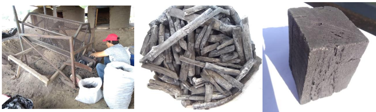
Figura 12 - Processo de seleção e classificação do carvão branco; Lado esquerdo (a) Peneira rotativa para separação e classificação; Centralizado (b) carvão branco em diferentes granulometrias; Lado direito (c) amostra após seleção destacando a estrutura porosa
