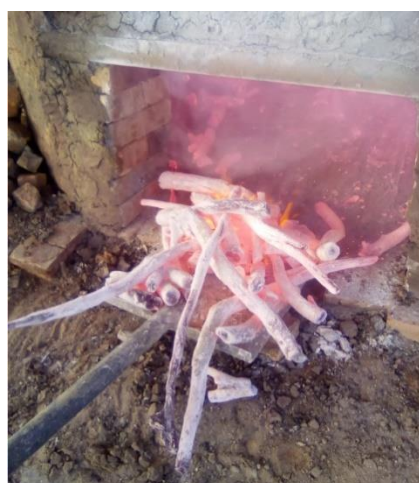
Figura 11 - Lado esquerdo (a) – ponto de retirada do carvão com temperatura \approx 1000°C e coloração alaranjada; lado direito (b) – Procedimento de retirada e resfriamento do carvão com o uso de areia e cinzas
