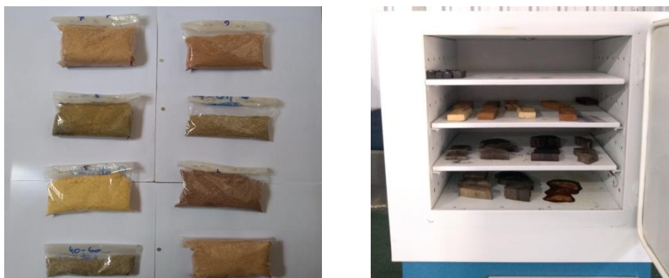
Figura 14 - Resíduos da biomassa utilizados para análise química e densidade básica; (a) Amostras da madeira classificada na fração 40/60 mesh para análises químicas; (b) amostras de madeira submetidas à análise de densidade básica
