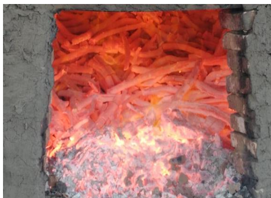
Figura 11 - Lado esquerdo (a) – ponto de retirada do carvão com temperatura \approx 1000°C e coloração alaranjada; lado direito (b) – Procedimento de retirada e resfriamento do carvão com o uso de areia e cinzas
