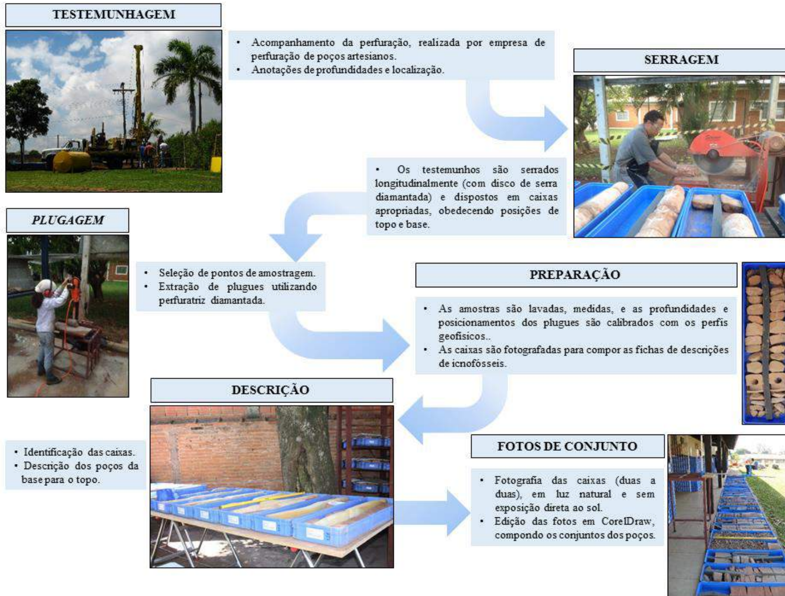
Figura 24. Procedimento empregado na coleta, preparação e descrição dos testemunhos dos poços analisados.
