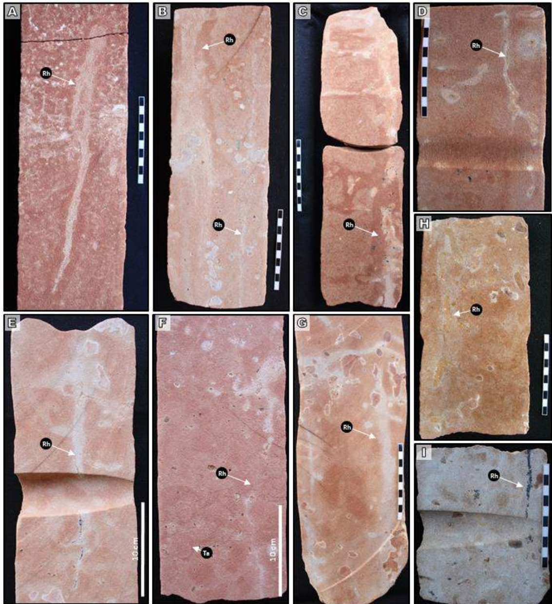
Figura 86. A-I. Traços de raízes (Rh) presentes na Formação Marília, observados no testemunho de sondagem do poço Quintana. A. Profundidade 86,66 m. B. Profundidade 97,50 m. C. Profundidade 91,80 m. D. Profundidade 98,60 m. E. Profundidade 111,40 m. F. Profundidade 127,10 m. G. Profundidade 106,60 m. H. Profundidade 65,50 m. I. Profundidade 46,85 m. Escalas em centímetros.
