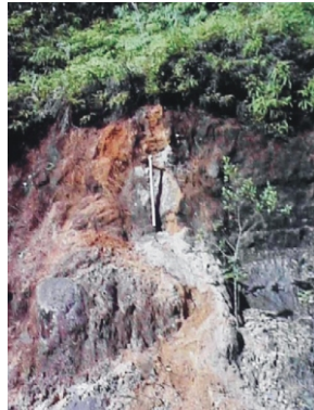
Foto 12 - Vista de perfil evidenciando contato entre o saprolito e o solo residual. Município de Cananéia - SP.
