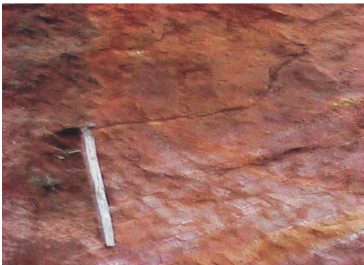
Foto 6 - Contato entre solo residual e saprolito. Município de Cananéia - SP.
