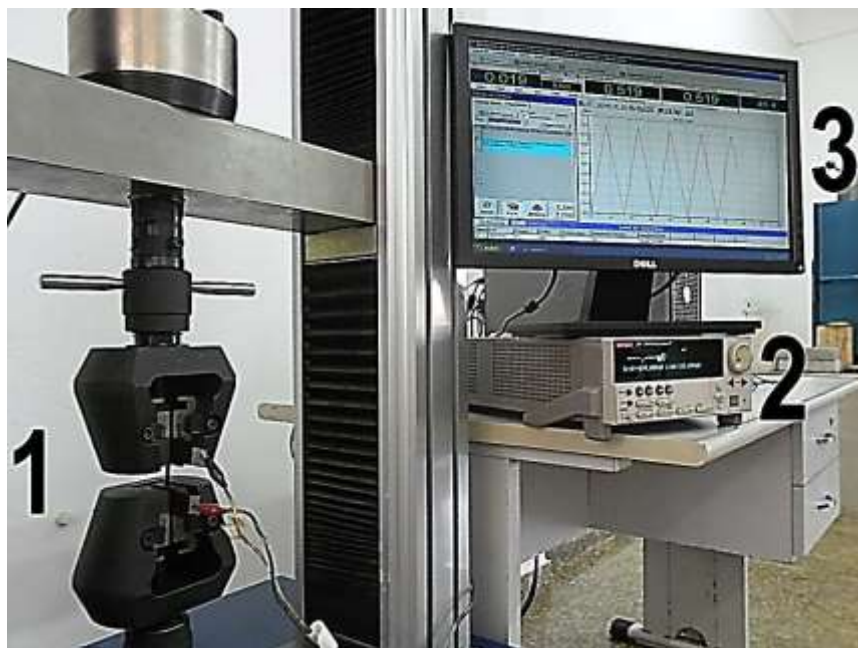
Figura 16 - Os equipamentos que realização os testes de piezoresistividade: (1) Equipamento Universal de Ensaio modelo WDW-30E, (2) Fonte Keithley modelo 2611 e (3) computador para aquisição de dados.
