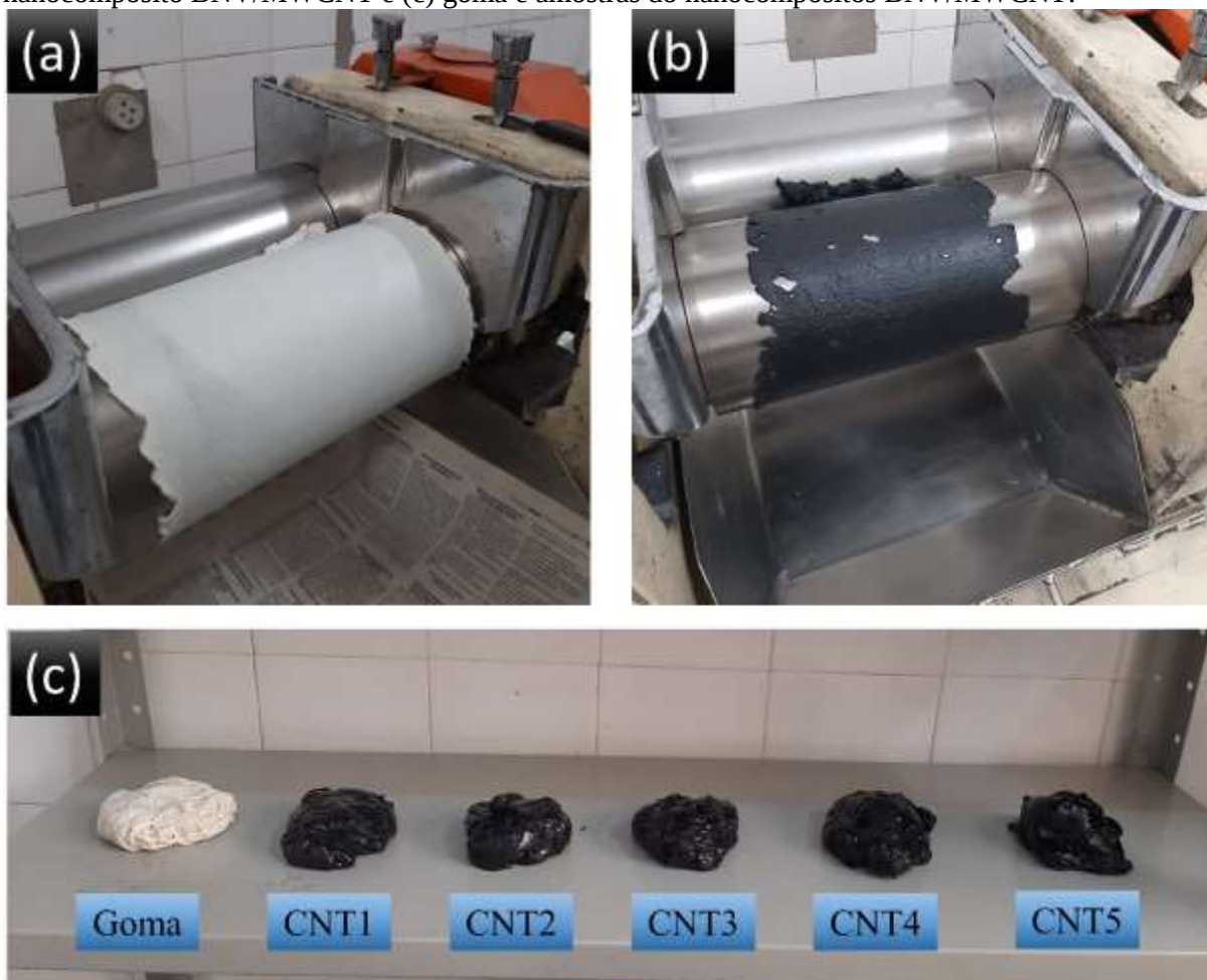
Figura 12 - Misturador aberto de rolos da marca Makintec. (a) BNV sem carga (goma referência), (b) nanocompósito BNV/MWCNT e (c) goma e amostras do nanocompósitos BNV/MWCNT.
