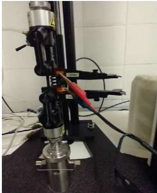
Figura 17 - Fita de metal envolvida por um material isolante entre a máquina universal de tensão-deformação e o eletrodo.
