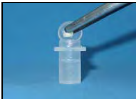
a. Colocação do dispositivo in situ de Leeds após liofilização sobre o bloco de metacrilato pré-polimerizado
