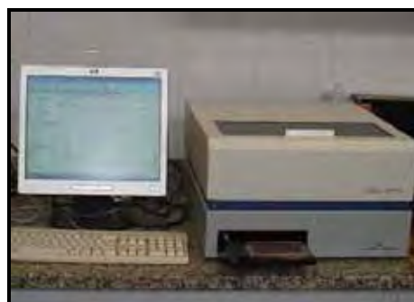
f. Análise das amostras em leitor de microplacas (FLUOstar OPTIMA, BMG Labtech, Alemanha) a 650 nm.
