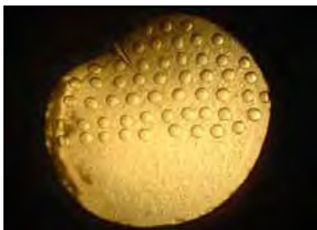
e. Amostras de fluido do biofilme tamponadas com TISAB III (acima) e gotas de TISAB III sem amostras (abaixo), sobre a superfície do eletrodo Orion 9409 (sob óleo mineral). O tamanho das gotas deve ser o mesmo, para que a proporção 1:10 (TISAB:amostra) seja mantido durante as leituras.
