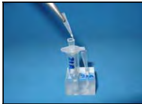
b. Imersão da ponta plástica (contendo biofilme) em óleo mineral, imediatamente após coleta, evitando-se a perda de umidade.
