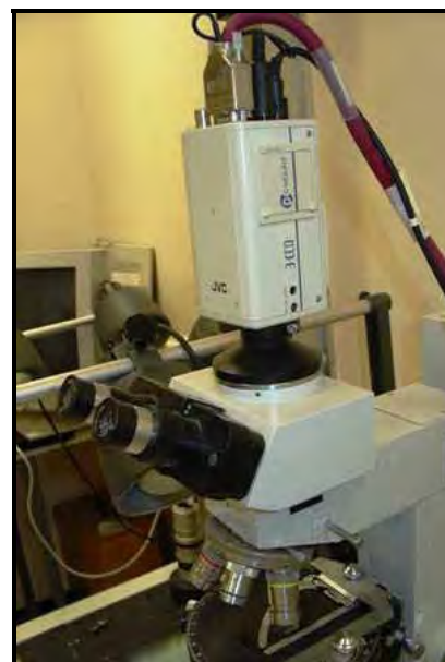
d. Câmara de vídeo (JVC 3-CCD) acoplada ao microscópio, utilizada na captura das imagens das secções de biofilme.
