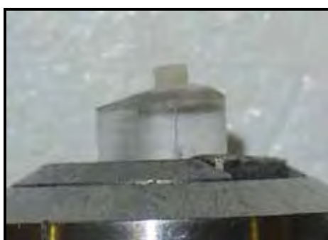
e. Aspecto final (vista lateral) da amostra de biofilme, embebida em metacrilato, após remoção do anel de resina composta.
