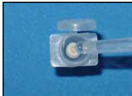
b. Colocação de mistura de metacrilato sobre o biofilme liofilizado. Deve-se encher até próximo da borda, devido à contração de polimerização .
