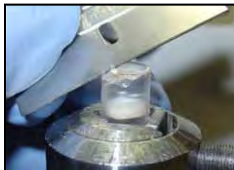
b. Remoção inicial dos excessos de metacrilato com lâmina metálica, realizada até as proximidades da amostra embebida.
