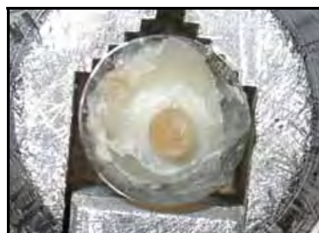
d. Aspecto final (vista superior) da amostra de biofilme, embebida em metacrilato, após remoção do anel de resina composta.
