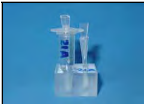
a. Tubo para microcentrifuga (esquerda) com tubo para coleta de biofilme, previamente preenchido com óleo mineral. À direita observa-se a ponta coletora de biofilme em seu suporte.
