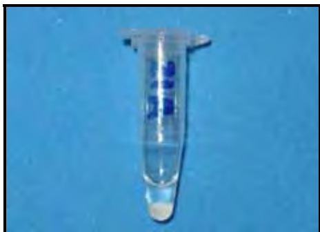
a. Fase sólida do biofilme na base do tubo, após extração do fluido, sob óleo mineral.
