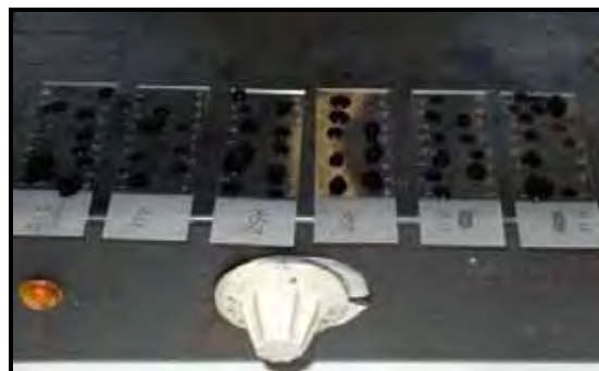
b. Aquecimento das lâminas de vidro contendo as secções de biofilme, permitindo a adequada pigmentação das secções e a subsequente evaporação do reagente de cor.
