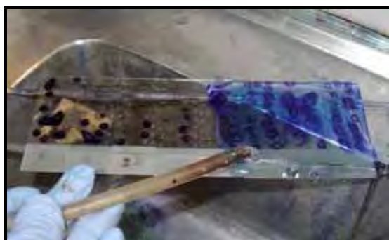
c. Lavagem das lâminas de vidro em água corrente. Toma-se o cuidado para não se utilizar um jato muito forte, o qual pode remover as secções de seu lugar original.
