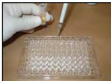
d. Colocação das amostras (2 \mu L), previamente tamponadas com TISAB III (1:10) nos poços da microplaca, aos quais previamente foram adicionados 100 \mu L de água deionizada.
