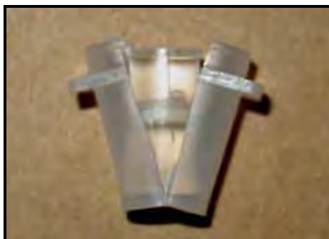
a. Remoção do bloco de metacrilato, no qual está embebida a amostra de biofilme.
