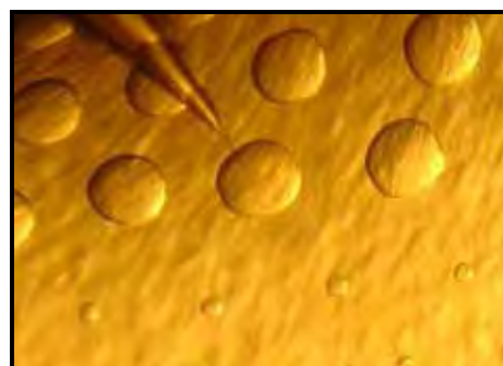
f. Vista aproximada do eletrodo de referência no interior do fluido do biofilme, tamponado com TISAB III sobre a superfície do eletrodo Orion 9409, sob óleo mineral. Abaixo, gotas de TISAB III.
