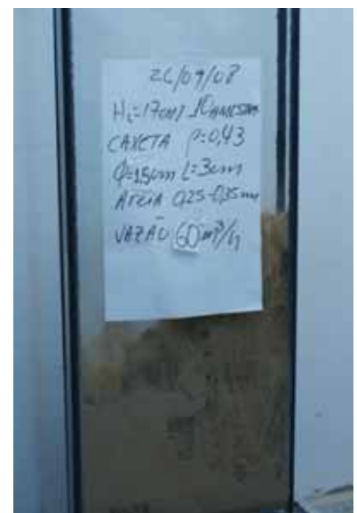
Figura 58: Informações do leito de 60 m 3 /H
