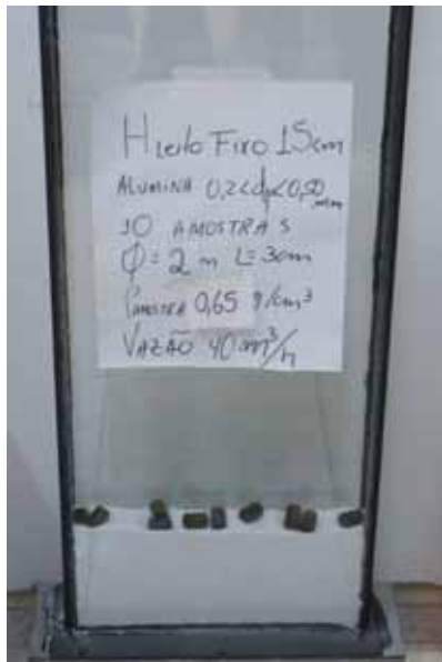
Figura 42: Informações do leito de 40 m 3 /H
