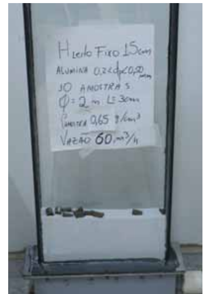
Figura 44: Informações do leito de 60 m 3 /H
