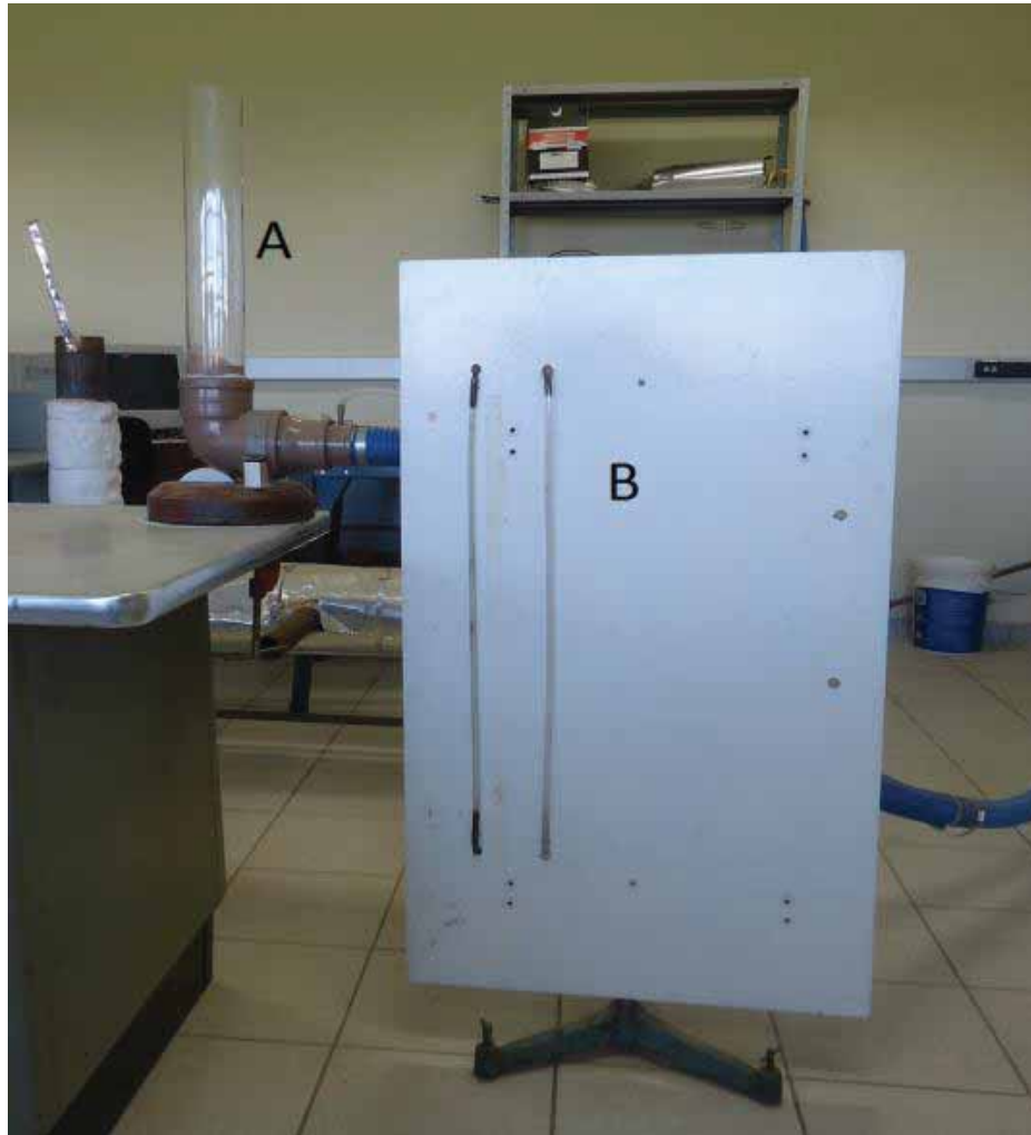
Figura 8: Em A: Mini leito frio fluidizado; Em B: Manômetro de coluna de água.
