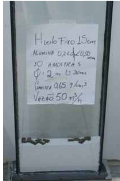
Figura 43: Informações do leito de 50 m 3 /H
