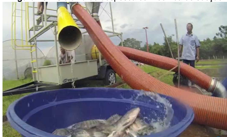
Figura 15 – Sistema de despesca com bomba de sucção
