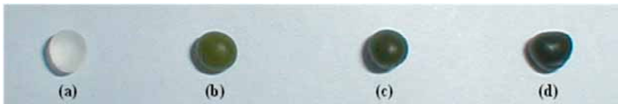
Figura 9 – Imobilização da biomassa Monoraphidium sp. em alginato de bário (2%). Concentração celular: (a) sem células; (b) 5.0 mg mL -1 ; (c) 10 mg mL -1 ; e (d) 20 mg mL -1 . Fonte: MACEDO, 2002.
