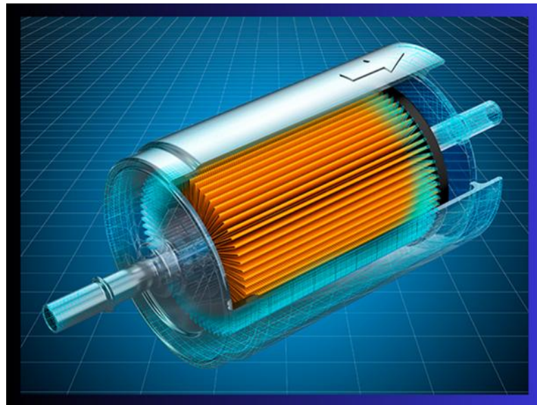
Figura 1 - Representação do meio filtrante no interior de um filtro.
