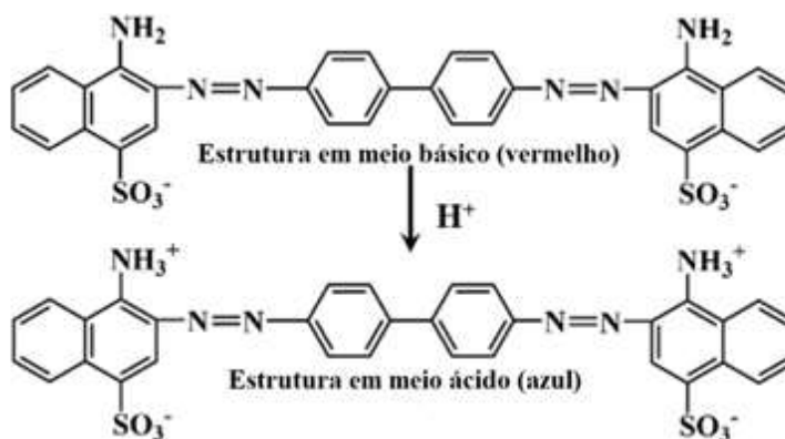
Figura 4. Estruturas do Vermelho Congo em condição básica e ácida
