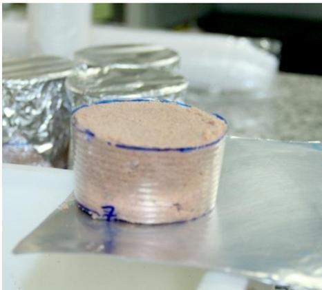
Figura 3. Estrato de solo (profundidade de 4-7cm) separado dos demais com auxílio da lâmina metálica.
