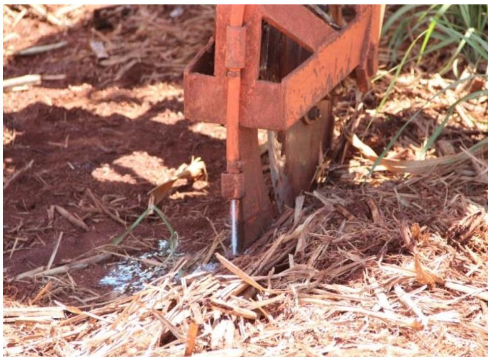
Figura 5: Detalhe do disco e do bico aplicador.
