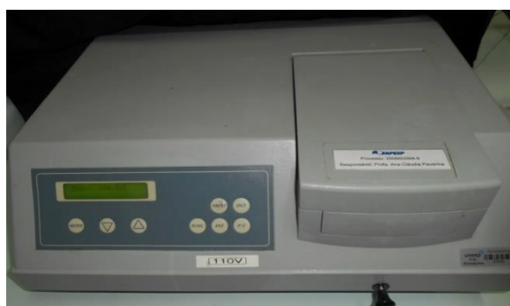
Figura 5 - Espectrofotômetro – Biospectro Modelo: SP-220 (450 nm). Faculdade de Odontologia de Araraquara, 2018.
