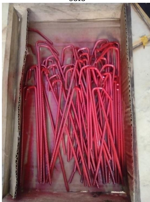
Figura 30 - Estacas de ferro confeccionadas manualmente e utilizadas para fixação da lona ao solo
