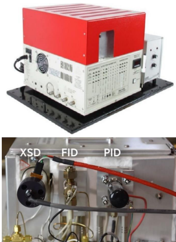
Figura 10 - Sistema de detecção do MIP com três sensores: PID, FID e XSD
