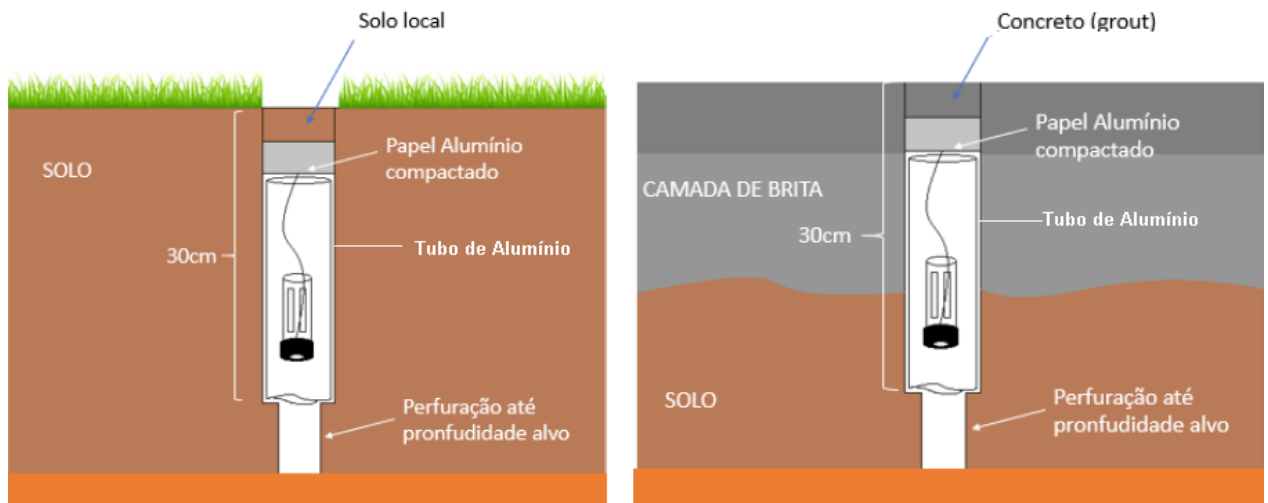
Figura 6 – Esquematização dos amostradores Vsorber® instalados em solo e no asfalto, respectivamente
