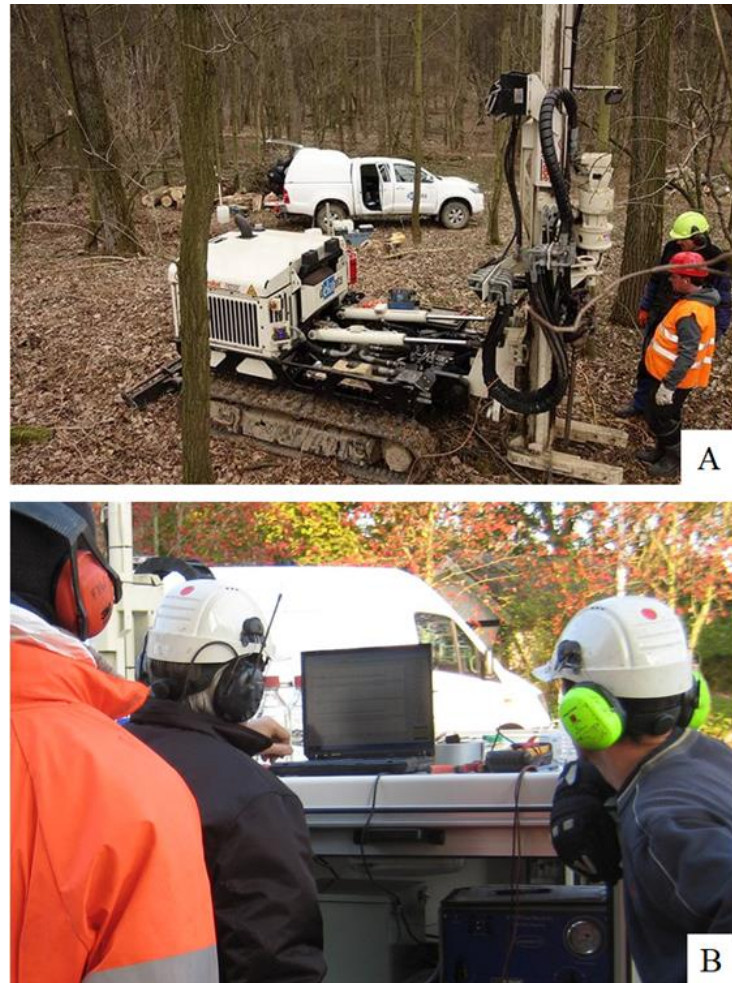
(A) Realização do ensaio pelo MiHpt (B) Visualização dos resultados em tempo real
