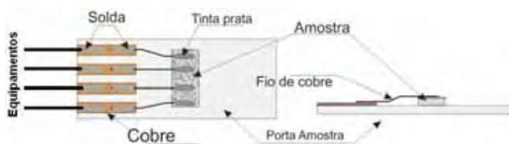
Figura 25: Esquema de montagem da amostra no porta amostra [29] .
