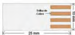
Figura 24: Esquema do porta amostra depois do processo de corrosão.
