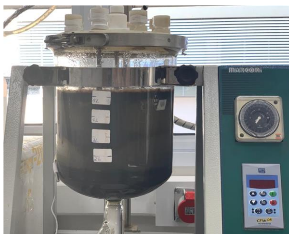
Figura 6 - Reator ASBR utilizado
