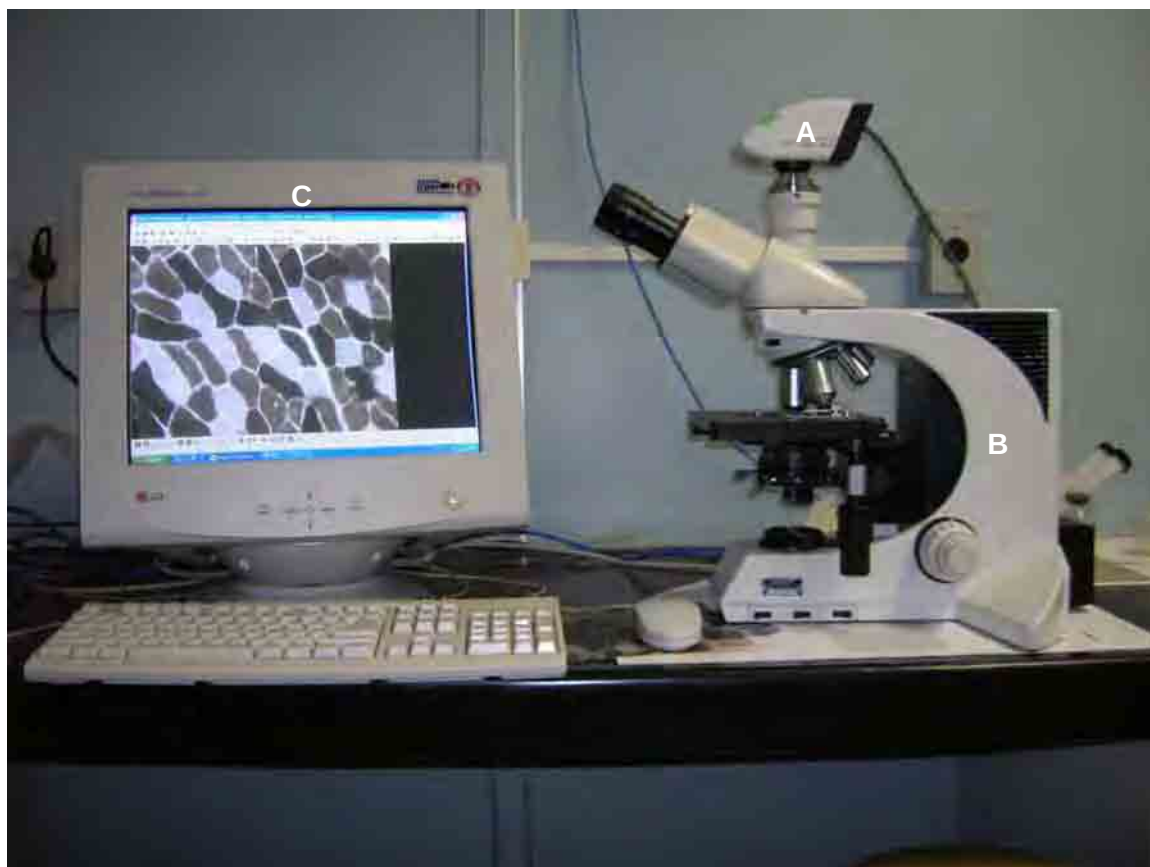
Figura 10. Câmera de Captura de Imagens Leica DFC 300 FX (A); Microscópio Leica DM-LB (B) e Sistema Computadorizado para Análise de Imagens, o Software Leica Qwin Standard V 3.1.0 (C).
