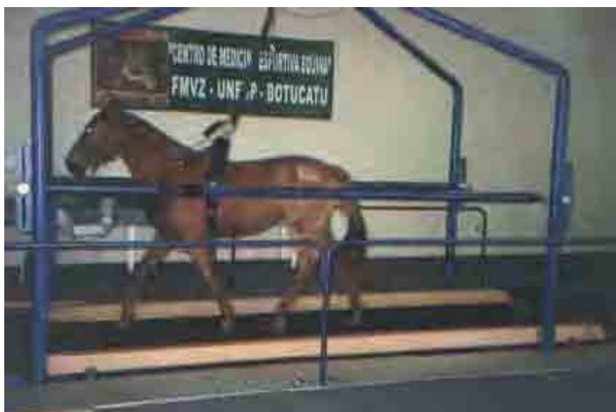
Figura 2. Esteira Ergométrica Kagra 2200 – Mustang mostrando cavalo acoplado ao cinto de segurança.
