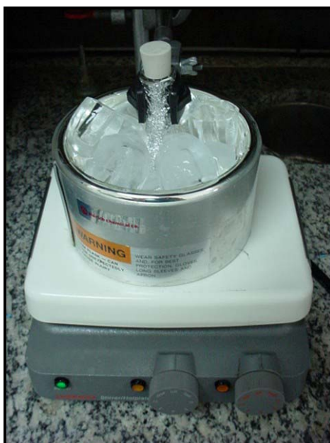
FIGURA 12 - Balão em banho de gelo durante a agitação magnética, para extração do monômero residual
