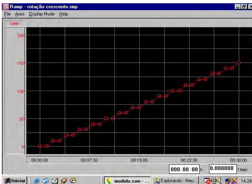
Figura 21 - Rampa de velocidade com rotação de 0 a 2,5 \text{ s}^{-1} .
