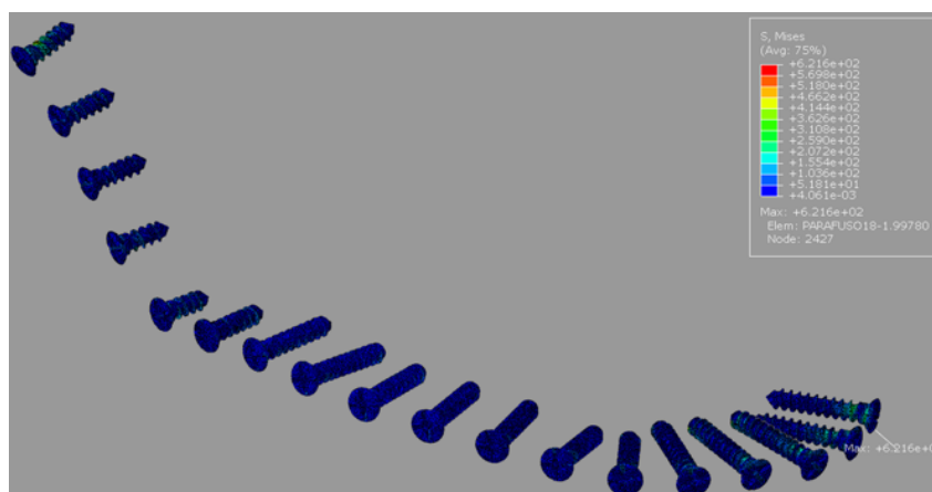
Figura 28 - Distribuição da tensão dos parafusos sobre placa recon standart de 2.85 mm em mandíbula atrófica (Grupo 1)
