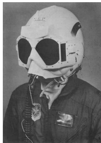
Figura 10: Óculos protetores (identificados como EEU-2/P), contra ofuscamento por clarão ( flash blindness ), usando pequenas lentes baseadas em PLZT.
