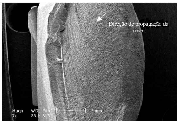
Figura 2.11 – Micrografia de uma fratura cordal (região do enchimento) em uma válvula de escape. Notam-se as marcas de praia e o ponto de nucleação da trinca (YU; XU, 2006).
