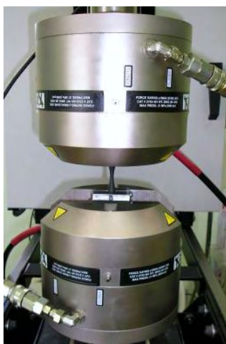
Figura 3.4 – equipamento utilizado para os testes de tração e fadiga
