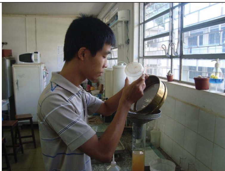
Figura 30. Lavagem da fração de areia de cada amostra na peneira.
