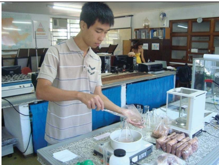
Figura 27. Pesagem de 10g de amostra para cada erlenmeyer.
