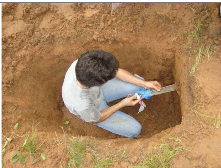
Figura 21. Retirada das amostras de material sedimentar da trincheira, para análise física (textura e fracionamento).
