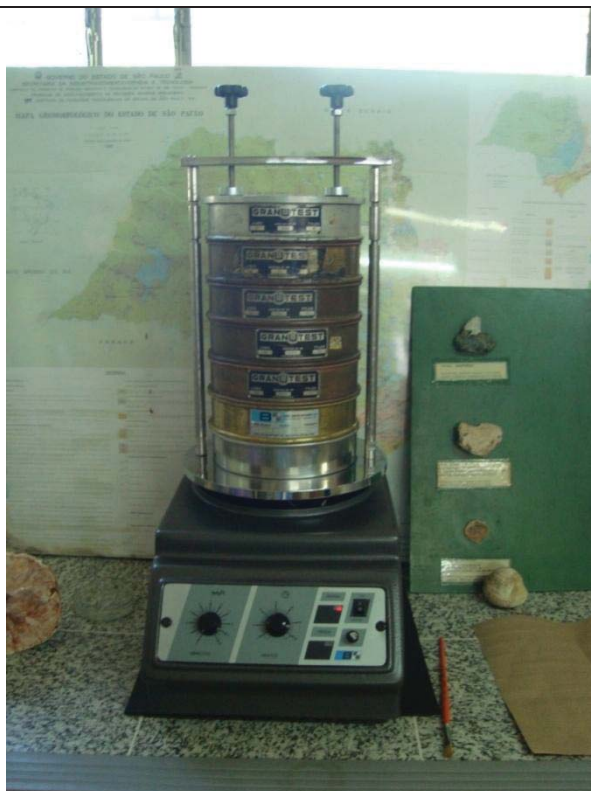
Figura 36. Fracionador montado com o conjunto de peneiras de cima para baixo com as frações de 2,0 mm, 1,0 mm, 0,5mm, 0,25mm, 0,125mm e 0,053mm.
