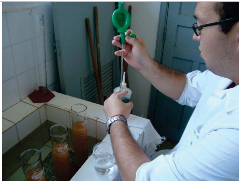
Figura 33. Pipetagem da argila da solução da proveta.
