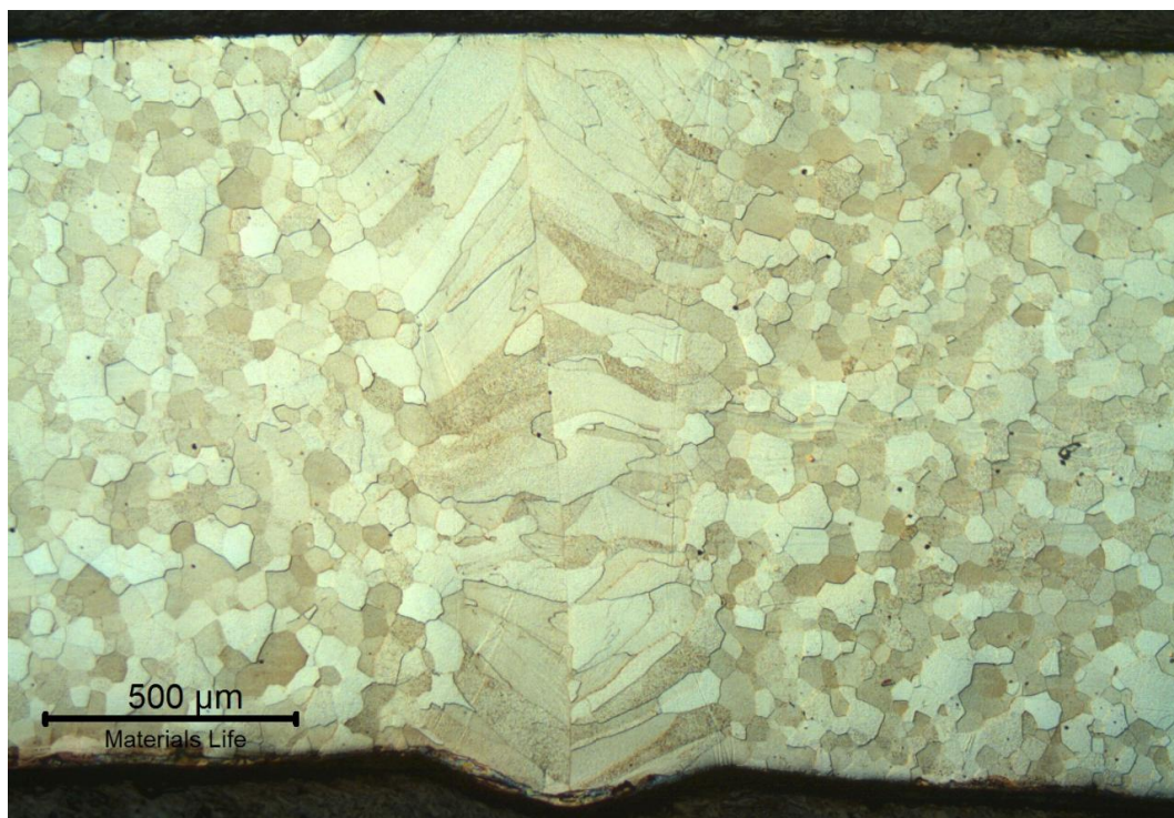
Figura 7 – Solda autógena em aço inoxidável ferrítico.
