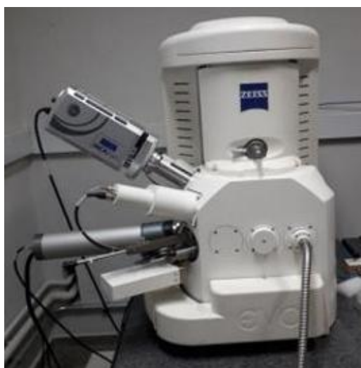
Figura 37 – Microscópio Eletrônico de Varredura (MEV) Zeiss - Modelo EVO LS15, utilizado para análise micrográfica das amostras.
