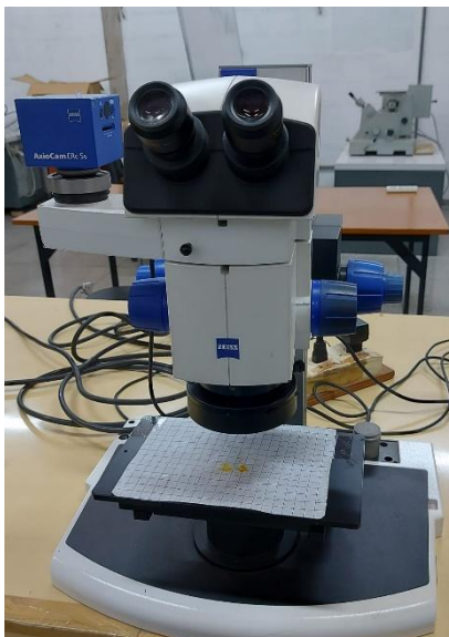
Figura 36 – Estéreo Microscópio Zeiss – Discovery V8, utilizado para análise macroscópica das amostras.
