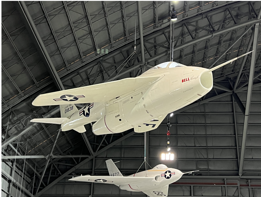
Figura 3 – Primeiro jato transônico, Bell X-5BE, com difusor de choque normal.
