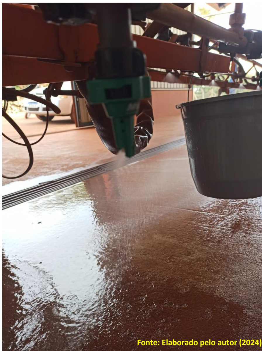
Figura 3 – Coleta da calda de pulverização pós-lavagem do sistema hidráulico com uso do balde.
