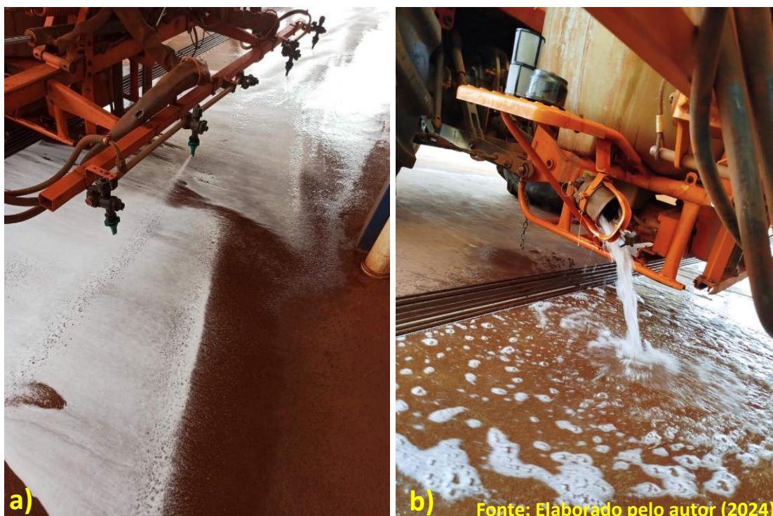
Figura 2 – Procedimentos de a) aplicação; e b) esvaziamento do tanque de pulverização.
