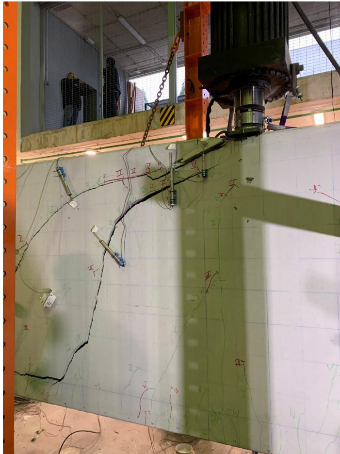
Figura 3 – Padrão de fissuração observado no ensaio desenvolvido pelo Grupo de Construção da Universidade da Coruña.
