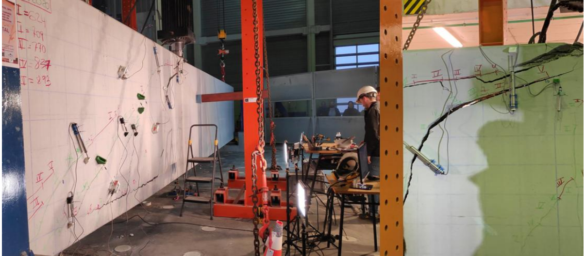
Figura 2 – Padrão de fissuração observado no ensaio desenvolvido pelo Grupo de Construção da Universidade da Coruña.
