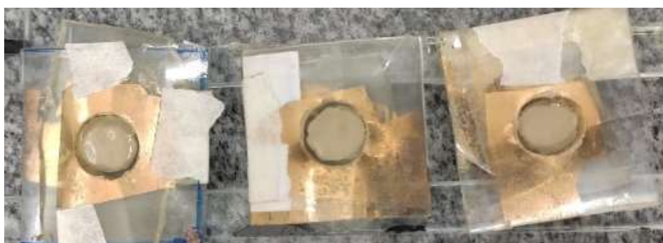
Figura 4: Amostra pura (100% epóxi) metalizada com tinta condutora
