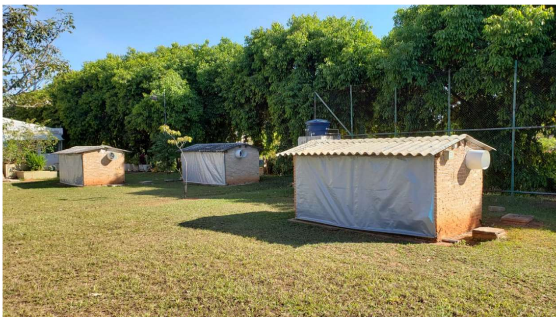
Figura 7. Foto panorâmica dos aviários em escala reduzida e distorcida utilizados neste estudo.
