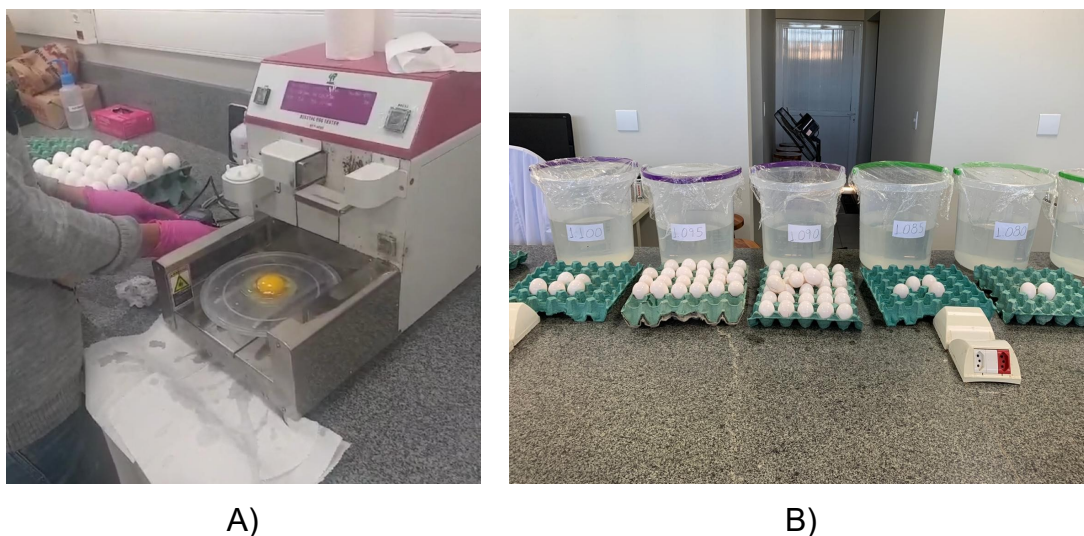
Figura 13. Laboratório de Conforto Ambiental com detalhe na A) máquina DET-6000® da Nabel utilizada para a análise da qualidade dos ovos e B) recipientes com solução salina utilizados para registro da gravidade específica dos ovos.
