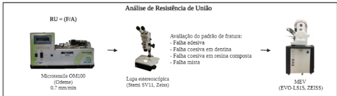
FIGURA 3 - Desenho esquemático da análise de resistência de união e padrão de fratura
