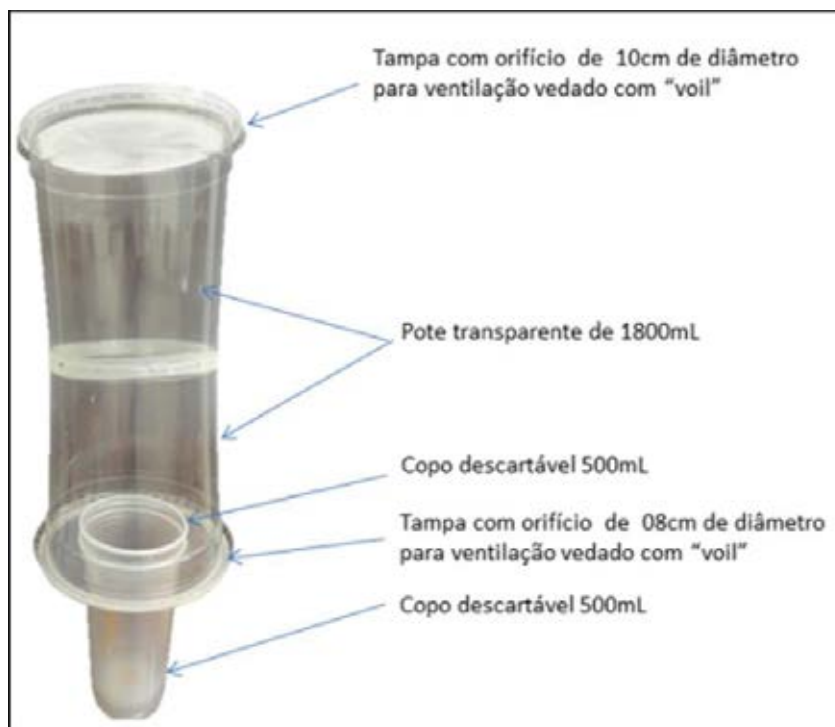
Figura 1- Características da gaiola de criação e oviposição de mosca-branca, confeccionada com 2 potes de polietileno transparentes de 1800mL, acoplados pela base, de modo a encaixar o copo plástico de 500mL com a planta da cultivar de algodoeiro .
