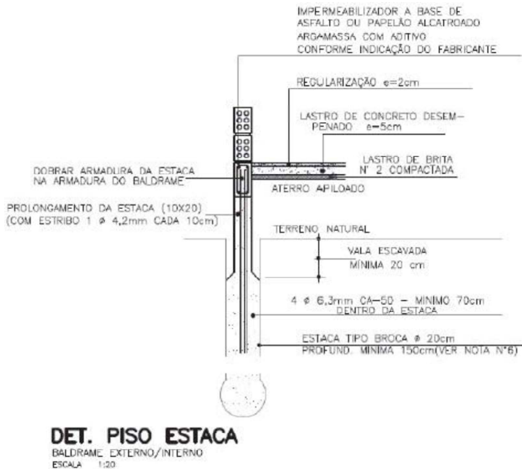
Figura 20 – Detalhes do contra piso e das estacas
