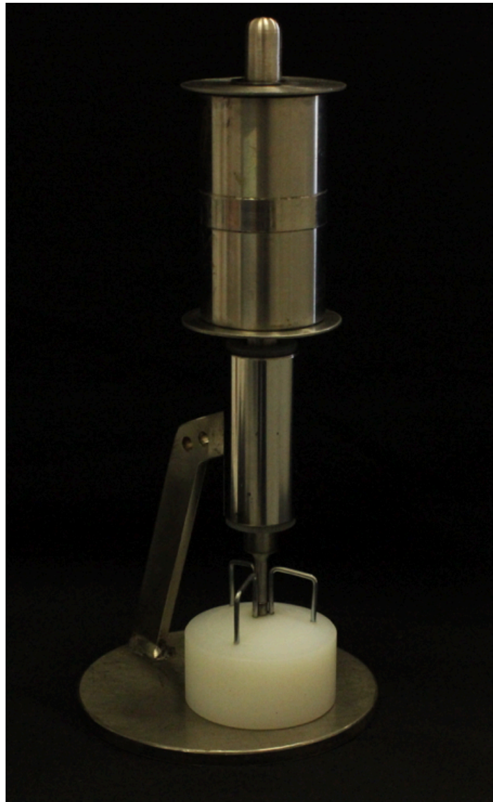
Figura 4 – Dispositivo utilizado para a cimentação dos discos de zircônia e de resina composta, com carga de 1000 gf
