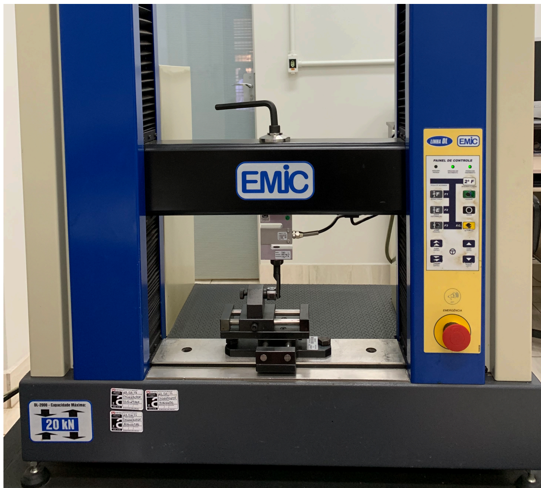
Figura 7 – Máquina de ensaio eletromecânica acoplada à célula de carga e ao dispositivo utilizado para o ensaio
