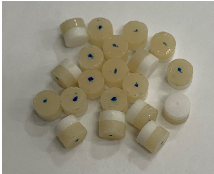
Figura 6 – Espécimes representativos obtidos após a cimentação dos discos de zircônia e de resina composta
