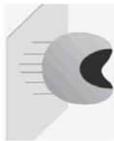
Figura 3 – Imobilização da enzima por ligação covalente multipontual: enzima ligada ao suporte por vários braços espaçadores (GUISÁN, 2006).
