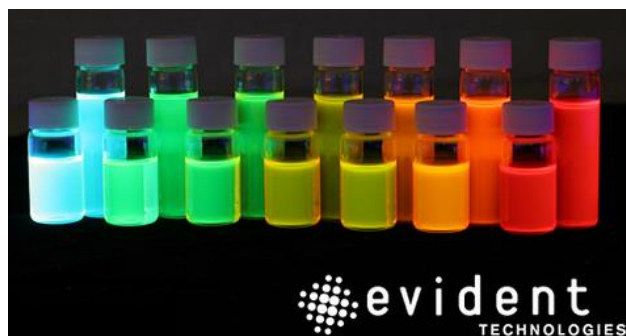
Figura 3. 4 – Variação de cores de emissão de dispersões coloidais de nanocristais de CdSe/ZnS em tolueno excitados por luz UV.
