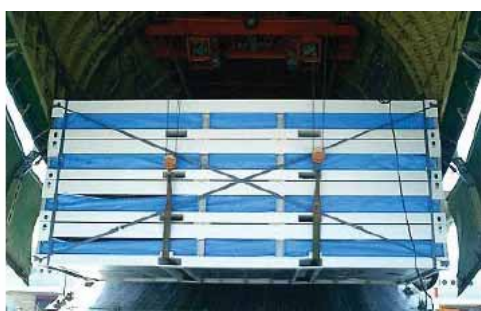
Figuras 19 e 20: Abrigo desenvolvido pelo exército americano, chamado COGIN – desmontado para transporte e montado in loco. Fonte: FREITAS (2009)
