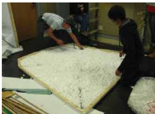
Figura 54: Alunos testam a embalagem plástica de amendoim como isolante térmico. Fonte: http://www.dosomething.org/
