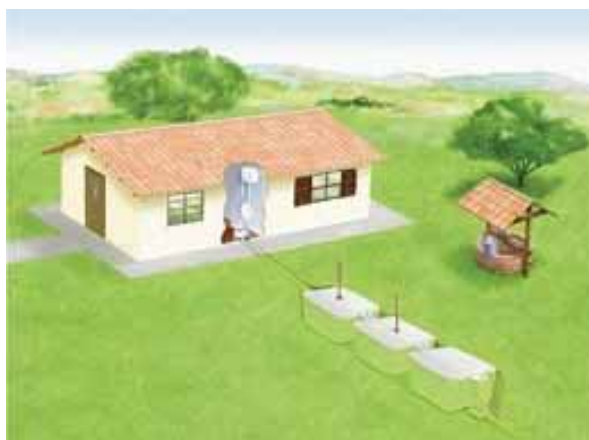
Figura 71: Esquema da fossa séptica biodigestora. Fonte: Embrapa
