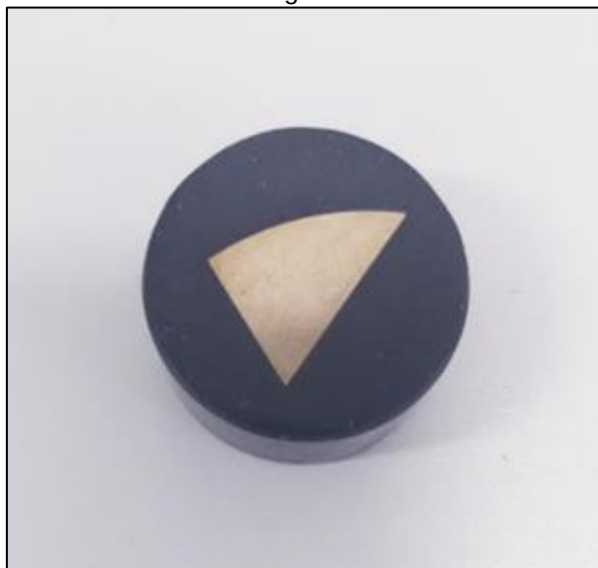
Figura 23 - Amostra metalográfica do Inconel 718 roleteado.
