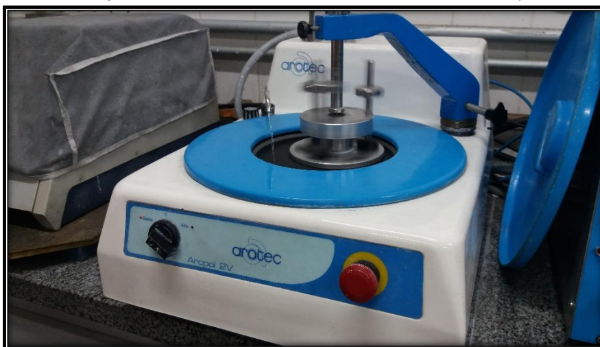
Figura 24 - Politriz/Lixadeira utilizada no lixamento e polimento.
