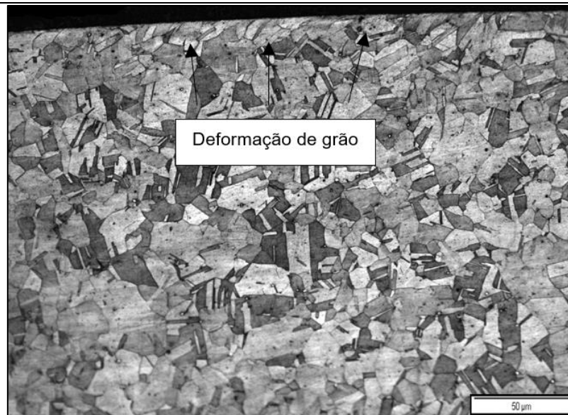
Figura 56 - Microscopia ótica após o 1º passe de roleteamento à 310° C 310°C – Passe 1
