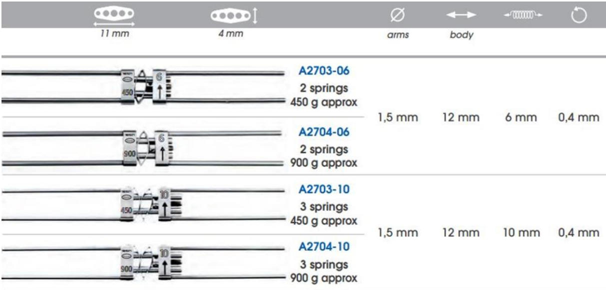
Figura 4 – Modelos de expansores LEAF Expander com 6 mm e 10 mm com forças de 450g e 900g.
