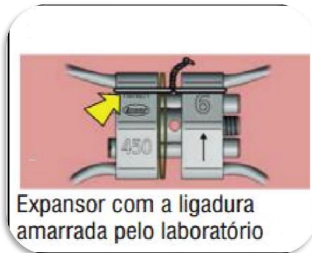
Figura 6 – Modelo de expensor cimentado antes de remover o fio de amarrilho.
