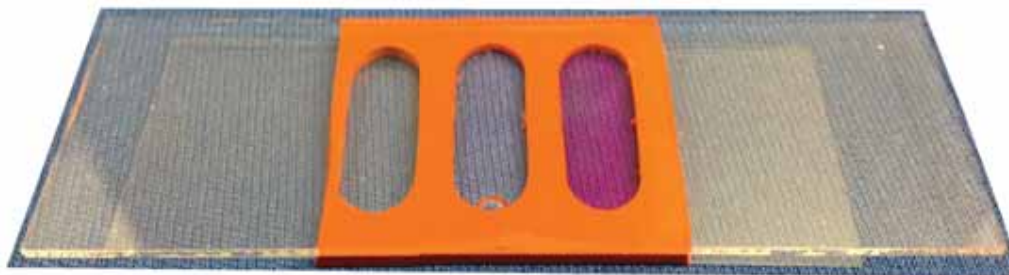
Figura 12: célula de observação contendo três compartimentos para a observação das GUV.
