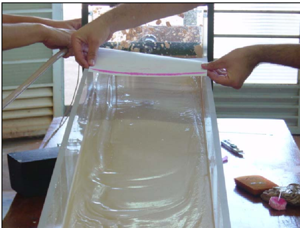
Figura 71 - Lançamento do traçador (canal de dimensões 30 cm de largura por 200 cm de comprimento).
