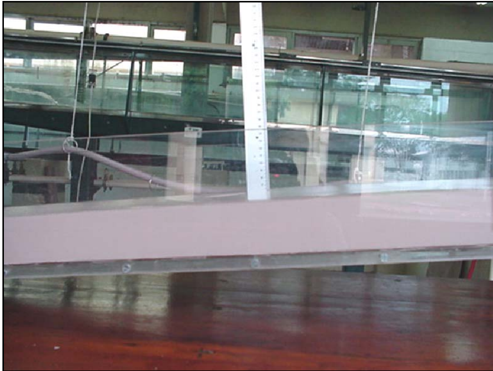
Figura 73 - Determinação da altura da lâmina.
