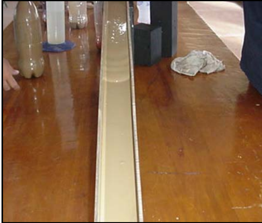
Figura 65 – Vista superior do escoamento (água+argila).
