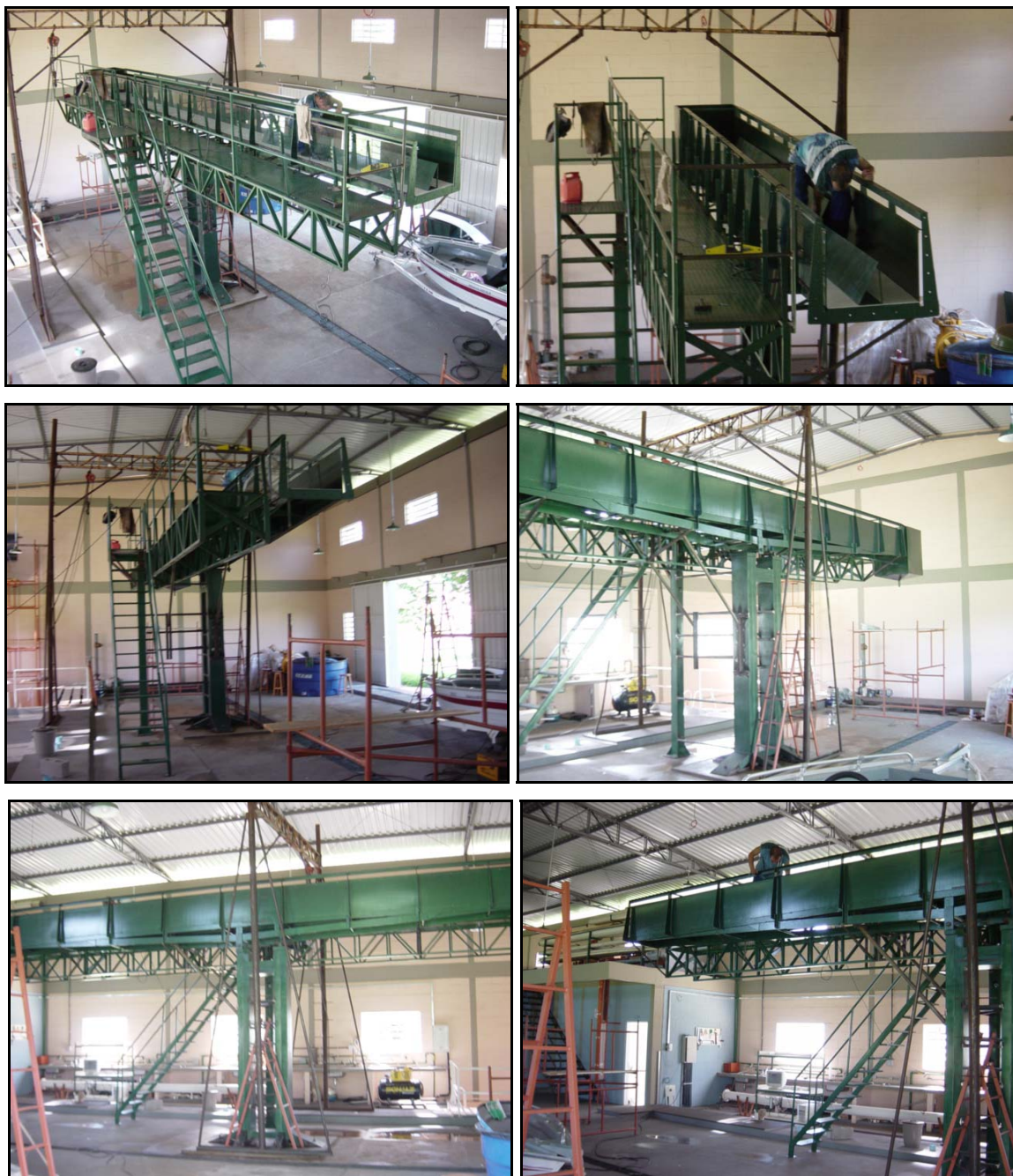
Figura 76 – Canal Residente construído no Laboratório de Hidrologia e Hidrometria da FEIS/Unesp (antes da instalação do sistema de recirculação).
