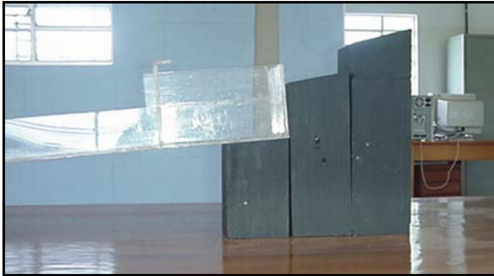
Figura 63 – Detalhe do aparato para a variação da declividade.
