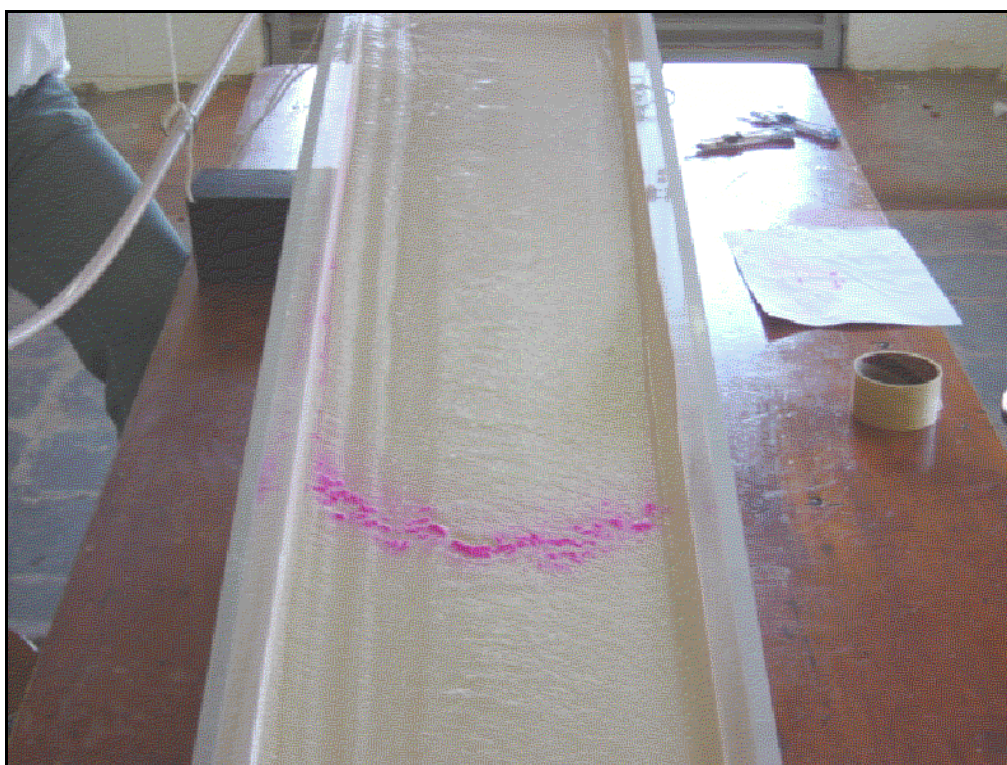
Figura 72 - Abertura da pluma (canal de dimensões 30 cm de largura por 200 cm de comprimento).
