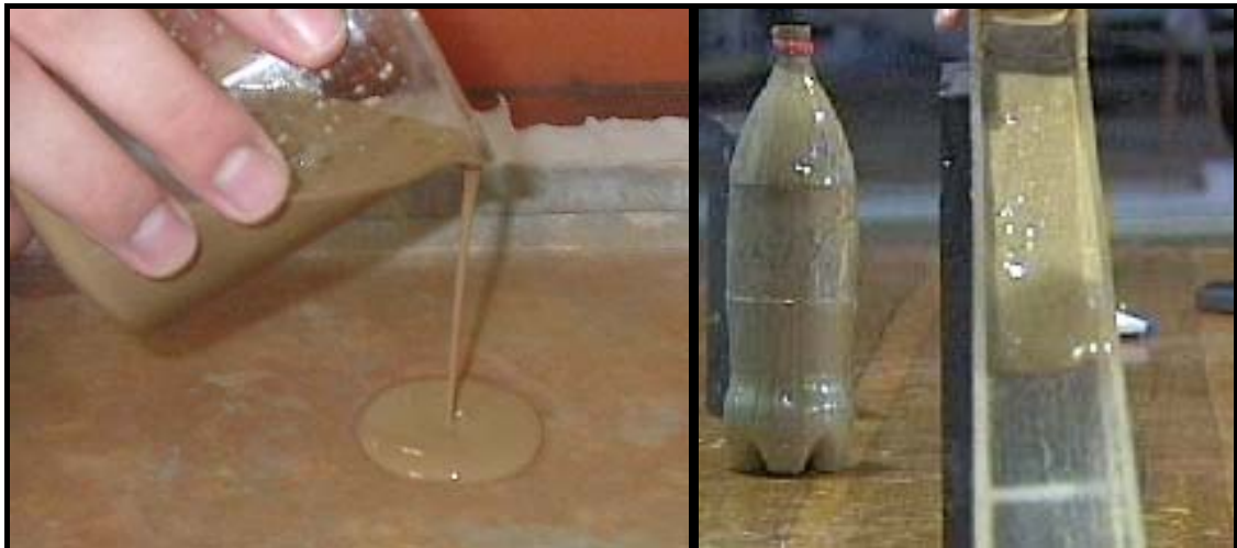
Figura 5b-Escoamento de mistura água+argila (Laboratório de Hidrologia e Hidrometria – FEIS/Unesp)
