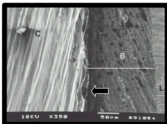
FIGURA 32- Técnica de afiação 3 mostrando ângulo de corte acentuadamente irregular, projeções metálicas funcionais em direção da face coronal (seta) associados a formação de bisel (B) (Grau 4)
