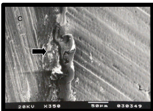
FIGURA 44- Técnica de afiação 9 mostrando ângulo de corte acentuadamente irregular e projeções metálicas não funcionais projetadas sobre a face lateral (seta) (Grau 3).
